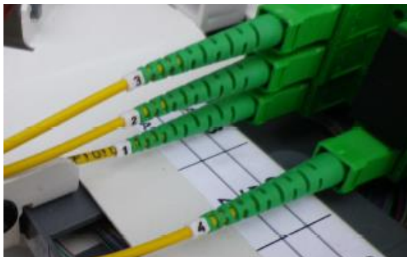
Figure 16. Exemple pose de cavalier sur cordon
